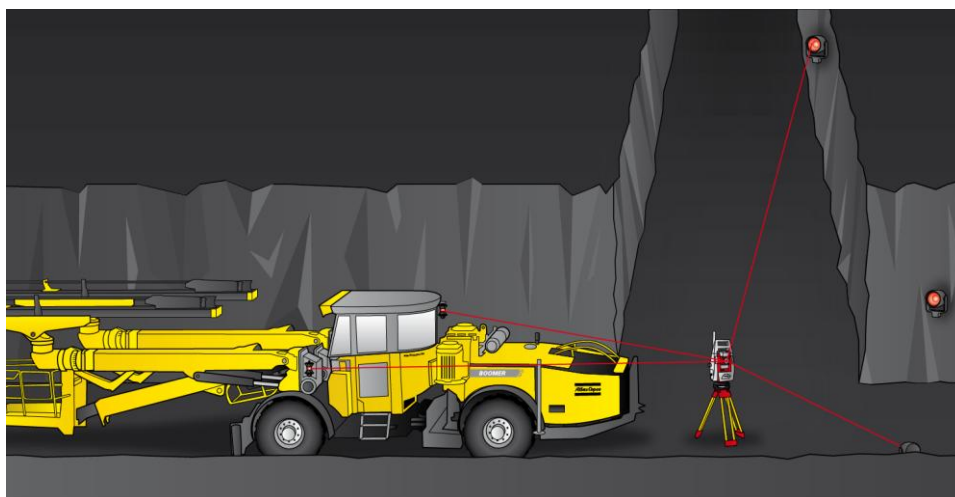
Figur 7. Princip för positionering med totalstation.
